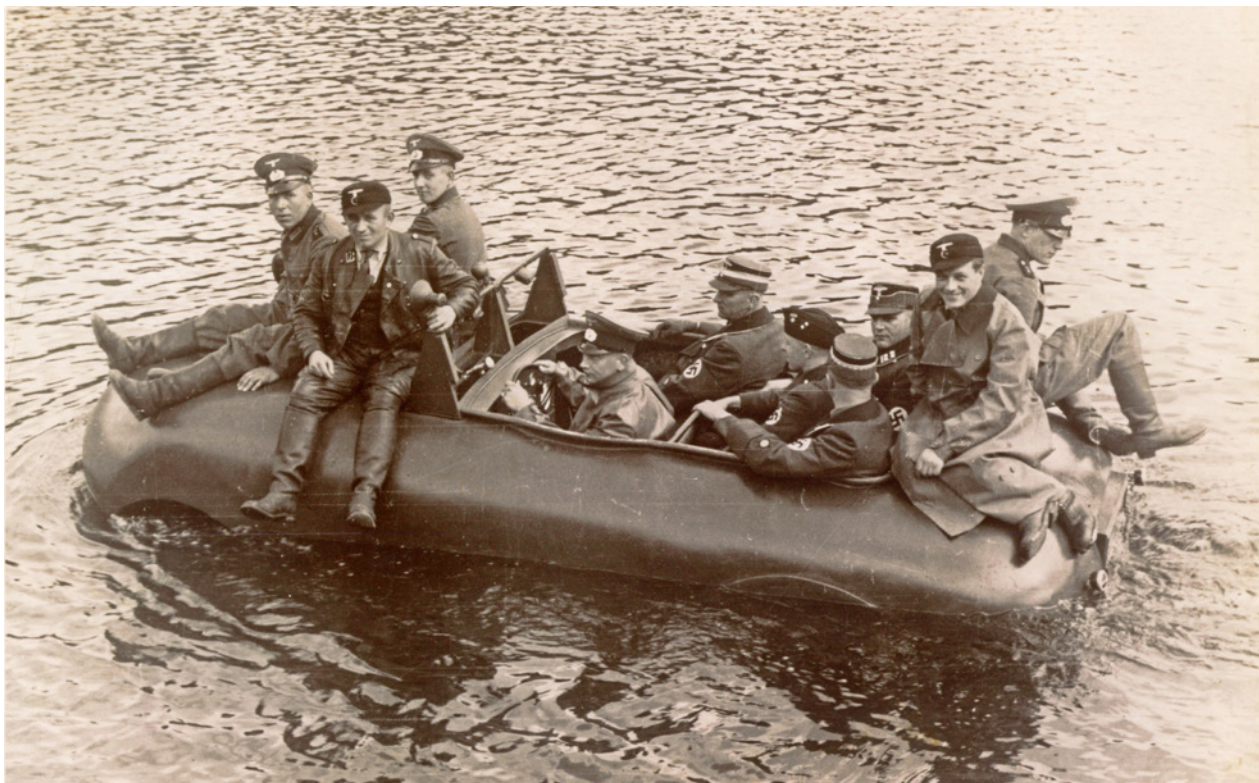
Test de flottabilité d'une voiture Trippel « SG 6 » (modèle standard) avec dix militaires à son bord en 1939. – Coll. J. Ziger.
